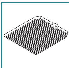
Die Aktivkohlefilter dienen dazu, die Gerüche in dem sie durchfließenden Luftstrom zurück zu halten. Die gereinigte Luft wird wieder in die Küche eingeleitet und durchströmt erneut die Aktivkohlefilter.
