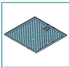
Les filtres métalliques anti-graisse ont pour fonction de retenir les particules grasses en suspension : ces dernières, déposées sur les filtres, alimentent d'éventuelles flammes dégagées pendant la cuisson, génèrent des odeurs peu agréables et compromettent le passage de l'air en réduisant la capacité d'aspiration de la hotte.
